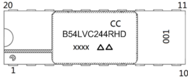
图 3-1 B54LVC244RHD 引脚排列图
