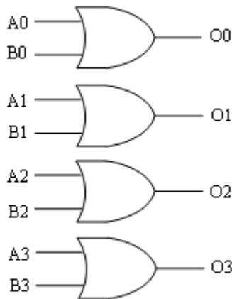
图 3-1 B54AC32 结构图
