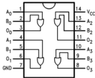
图 4-1 B54AC32 引脚排列图
